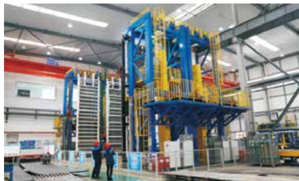
锅炉受热面INCONEL智能堆焊中心
